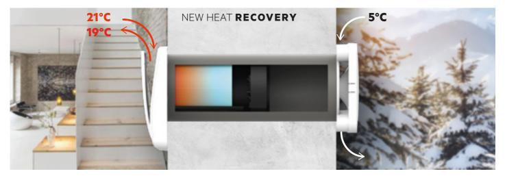
**PULSE 61** funziona a cicli alternati continui di 70 secondi: 70 secondi in cui l'aria ambiente viziata viene estratta verso l'esterno e 70 secondi in cui l'aria esterna, grazie all'inversione del senso di rotazione della motoventola, viene immessa nello stesso ambiente.
