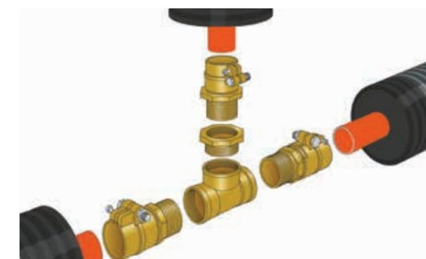
Esempio di collegamento a Tee per tubazioni PE-Xa - PE-Xa - PE-Xa
