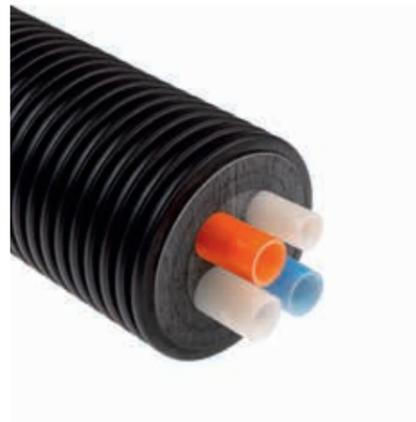
Tubazioni preisolate quaduple, molto flessibili, sono realizzate con all'interno due tubi per il riscaldamento / raffreddamento e due tubi per il sanitario, per impianti di riscaldamento / raffreddamento e di acqua sanitaria.
