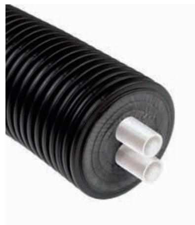
**Tubazioni preisolate doppie, molto flessibili, sono realizzate con due tubi interni, uno per l'alimentazione principale e l'altro per il ricircolo, per impianti di acqua calda sanitaria e di acqua fredda potabile.**
