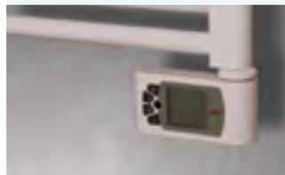
Resistenza elettrica ad innesto tramite fastom con controllo elettronico per regolare la temperatura ambiente. Classe di isolamento II. Grado di protezione IP44. L' elettronica è fornita in colore Bianco Standard (cod. 01) per radiatori bianchi; cromata per radiatori colorati.
